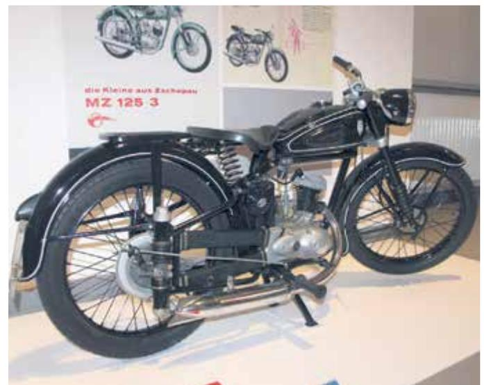
**DIET 125** wurde zwischen 1950 und 1954 produziert. Die „kleine“ MZ aus Zschopau mit dem 3-Gang-Schaltgetriebe konnte bis 75 km/h fahren.
