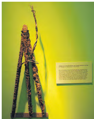
KLEINER DRAHT MIT großer Wirkung: ein historischer Blitzableiter. Foto: Trache
