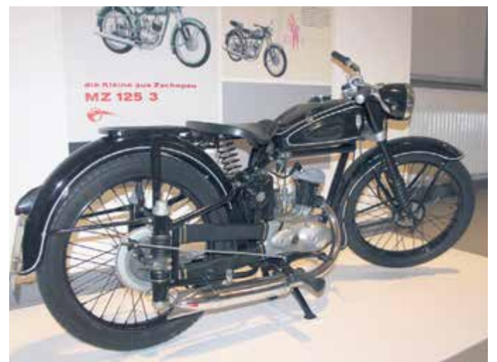
DIE RT 125 wurde zwischen 1950 und 1954 produziert. Die „kleine“ MZ aus Zschopau mit dem 3-Gang-Schaltgetriebe konnte bis 75 km/h fahren.
