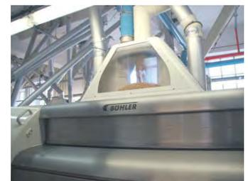
**EINE DER ZAHLREICHEN** Mahlmaschinen, in die oben das Korn hineinfällt und im geschlossenen Teil mit Walzen zermahlen wird.
